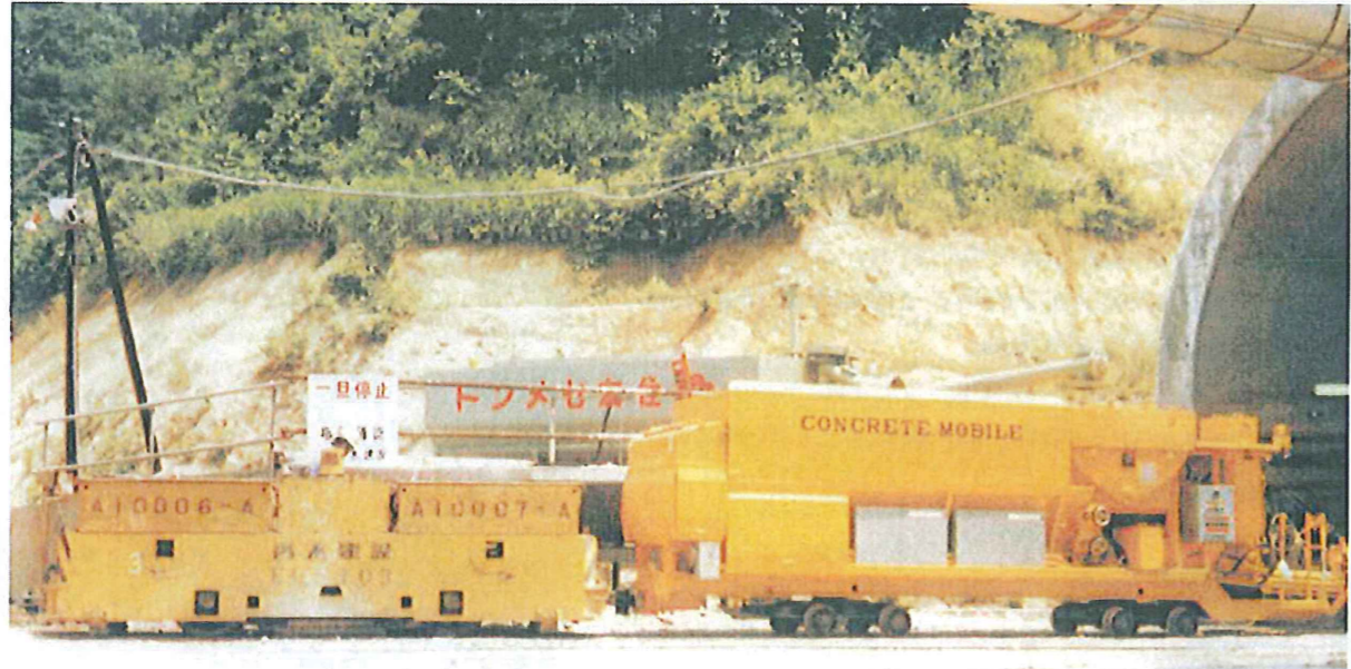
NATMでの施工例、レール台車搭載、CM-100T25C
