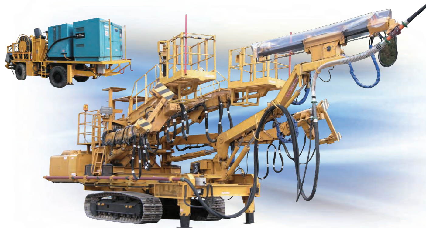
吹付ロボット付エレクター台車+後続ポンプ台車
